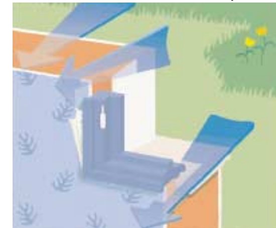
Les constructions à isolation répartie n'empêchent pas les ponts thermiques et favorisent la formation de moisissures.
