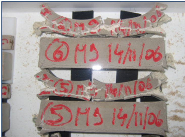
Figure 7 : Photos d'éprouvettes prismatiques (2x2x16 et 4x4x16 cm 3 ) après 4 mois d'immersion en solution agressive de sulfate de sodium
