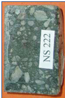
Figure 4 : Corps d'épreuve après essai NT Build 492. Le front de coloration indique la profondeur de pénétration des ions chlorures (Photo CEBTP)
