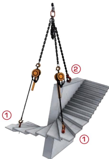
**2<sup>ème</sup> étape :** mettre en tension le 3<sup>ème</sup> brin, raccourci de 50 cm, relié à la boucle de levage en tête de mur ②. Les 2 autres brins sont reliés aux 2 palans à chaînes fixés aux câblettes d'équilibrage. L'escalier peut être alors relevé.
