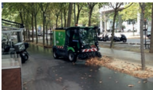
Photo 90 - Balayage et aspiration.
