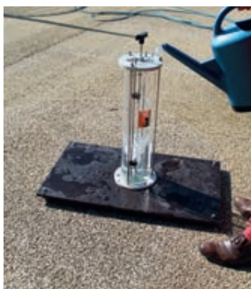
Photo 61 - Drainomètre permettant de mesurer la drainabilité d'un revêtement drainant in situ.
