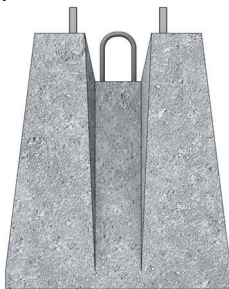
Figure 3 - Exemple d'implantation d'anneau de levage sur massif
