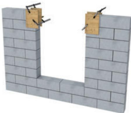
**2** Coffrez les réservations et déposez un lit de mortier.
