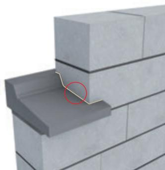
Pour contrer le phénomène de dilatation de l'appui de fenêtre et de la structure, qui entraînerait des micro-fissures source de dégradation ultérieure de l'appui et de l'enduit, il est conseillé de placer du polystyrène ou de la mousse d'une épaisseur de 5 mm aux extrémités de l'appui et de reboucher à l'aide de mortier bâtard les réservations en tableau.
