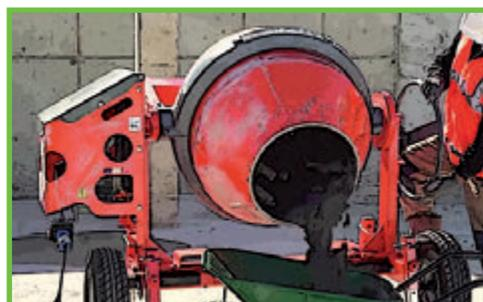
**5** Votre mortier est prêt, il doit être de consistance ferme comme un mortier de chape.
