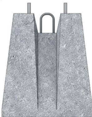
Figure 3 - Exemple d'implantation d'anneau de levage sur massif
