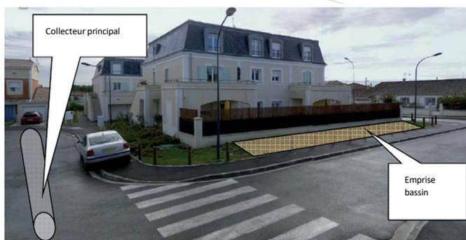
Figure 27 – Exemple d'implantation d'un bassin enterré constitué de tuyaux de grand diamètre vis-à-vis du collecteur principal
