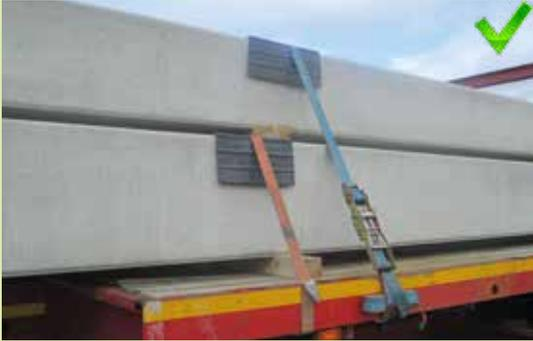
Les tendeurs à cliquets dit Ergonomique, inversés et débrayables sont plus ergonomiques pour le chauffeur qui n'a pas besoin de forcer à outrance pour atteindre la tension nominale dans la sangle
