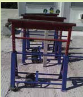
L'utilisation de tréteau est recommandée lors du chargement de remorque dételée, lorsque le chargement est déséquilibré
