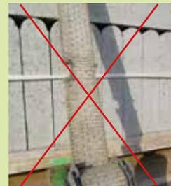
Interdiction d'utiliser une sangle avec un nœud, un trou ou même lorsqu'elles sont abimées ou déchirées. Les coutures noires présentes sur les sangles sont aussi un indicateur de l'état d'intégrité.
