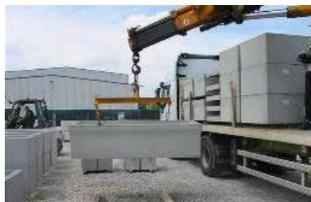
Pendant le transport à vide, la fourche ou « Cé de levage » doit être maintenu par un système d'accroche au tablier avant ou à la paroi arrière.
