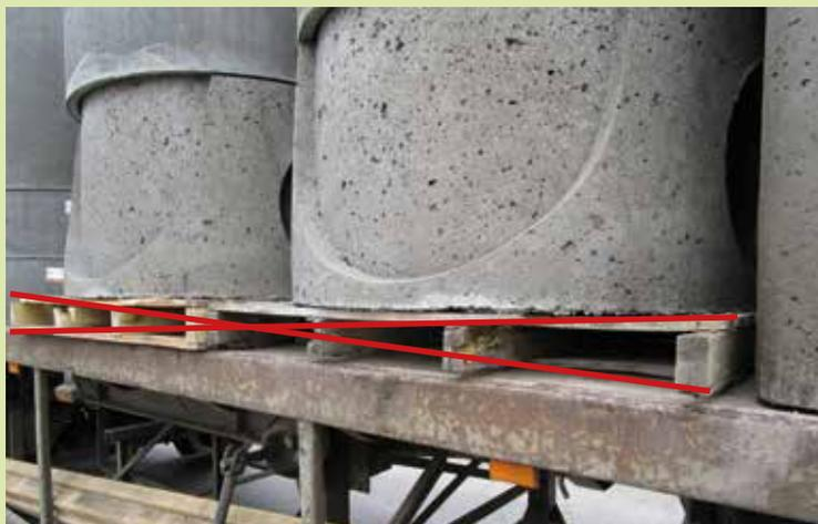
Les palettes doivent être de dimension et de résistance suffisante et adaptée à la charge transportée. Elles doivent par ailleurs être en bon état.
