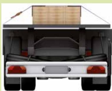
Pour un arrimage vraiment efficace, les deux palettes doivent avoir approximativement la même hauteur (l'angle  $\alpha$  formé entre la sangle et le plateau doit être le plus proche possible de  $90^\circ$ ).
