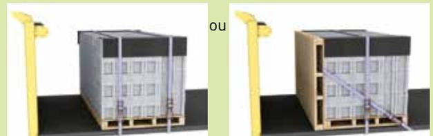
Si le chargement ne peut être calé, bloqué ou positionné contre le tablier, celui-ci doit être pourvu d'un arrimage de sécurité, empêchant le déplacement de la charge vers l'avant. Soit par un système de boucle en tête, soit par le doublement du nombre de sangles nécessaires
