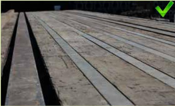
Plateau propre en bon état (point d'ancrage non visible)
