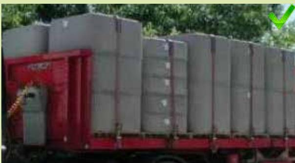
Dans la mesure du possible, charger les produits en béton sans aucun **vide longitudinal ni latéral** entre eux et en les calant **contre le tablier**. Idéalement la **distance entre les produits doit être inférieure à 8 cm**
