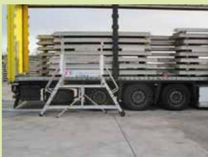
Plateforme roulante en aluminium à disposition des chauffeurs sur le parc de l'industriel du béton
