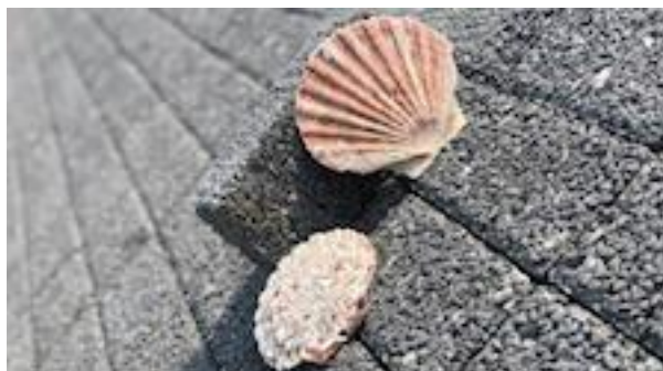
Pavés de voirie intéggrant des déchets de coquillages Hydrojoint - Alkern
